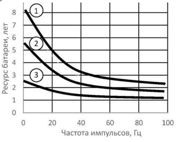
Рисунок 2.1 - Расчетный ресурс батареи в зависимости от частоты импульсов и времени работы дисплея и интерфейсов (1) - один час в месяц, (2) - пять часов в месяц, (3) - 24 часа в месяц
