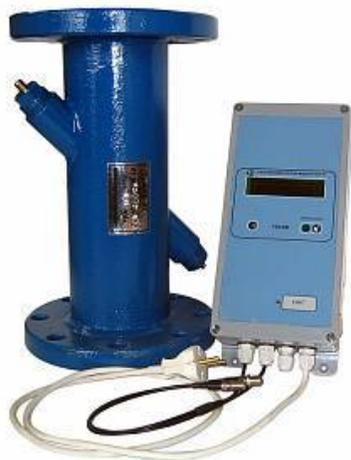
В состав СУР входит: блок электронного преобразования (ЭП), измерительный участок (ИУ), имеющий диаметр условный (Ду), от 25 до 2000 мм, кабель соединительный коаксиальный (КС). В случае, когда СУР монтируется на трубопроводе (Ду от 100 до 2000 мм), вместо ИУ в состав СУР входит установочный комплект: комплект пьезоэлектрических преобразователей (ПП), комплект патрубков и КС.
