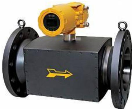
Диапазон размеров, изготавливаемых на сегодняшний день от Ду50 до Ду500мм. С учетом условий эксплуатации и требуемой точности измерений расходомеры могут быть оснащены от 3 до 8 измерительных лучей. Для включения в верхний уровень системы управления имеются протоколы Profibus, Fieldbus Foundation и Hart. Расходомеры могут использоваться как в обычной, так и взрывоопасных зонах.
