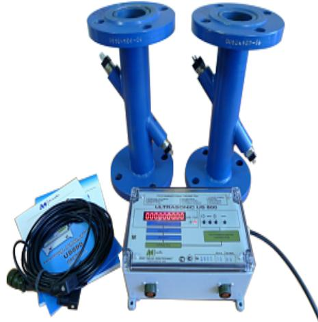
Принцип действия расходомеров-счетчиков жидкости ультразвуковых US800 основан на измерении времени распространения импульсов ультразвукового колебания через двигающуюся жидкость. Разность между временами распространения ультразвуковых импульсов в прямом и обратном направлениях относительно движения жидкости пропорциональна скорости ее потока и, следовательно, ее расходу.
