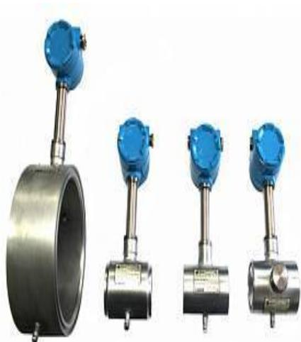
В основе принципа работы датчиков расхода использован «вихревой» способ преобразования скорости потока, обеспечивающий линейное преобразование объемного расхода газа (пара) при рабочем давлении в электрический частотный сигнал или электрический импульсный сигнал с нормированной ценой и в токовый сигнал 4-20 мА.
