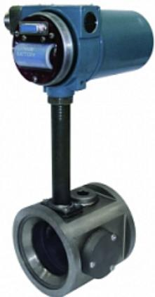
Принцип вихревого измерения расхода состоит в измерении скорости потока путем определения частоты образования вихрей за телом обтекания, установленным в проточной части расходомера. Определение частоты вихреобразования производится при помощи ультразвука, имеющего частоту 1 МГц – ультразвуковое детектирование вихрей. Какие-либо
