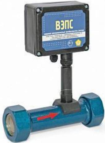
По типу выходного электрического сигнала производятся преобразователи расхода с ненормированным (частотным), нормированным на единицу объёма (импульсным) выходом, а также с токовым унифицированным выходом 4-20mA. При этом, в зависимости от диаметра проточной части, первичные преобразователи, сохраняя основные элементы конструкции, подразделяются на конструкции малых (Ду20-50), средних (Ду80-150) и больших диаметров (Ду200-300).
