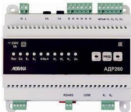
Адаптер предназначен для работы с тепловычислителем СПТ963, который может обслуживать до четырех контуров регулирования теплоснабжения или горячего водоснабжения. К одному тепловычислителю могут быть подключены от одного до четырех адаптеров по последовательному интерфейсу связи с адаптерами (RS485). Адрес адаптера и скорость обмена по интерфейсу RS485 устанавливаются при работе в тестовом режиме с использованием выведенных на лицевую панель индикаторов состояния и кнопок управления.
