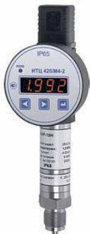
Датчики оснащены современными тензорезистивными сенсорами с металлическими и керамическими мембранами. Тензорезистивные сенсоры с металлической разделительной мембраной из нержавеющей стали 316L, выполненные по технологии КНК, имеют высокую перегрузочную способность до 300% от верхнего предела измерений. Примененные в датчиках керамические сенсоры обладают высокой стойкостью к перегрузкам (до 600%) и особо высокой стойкостью к агрессивным средам.
