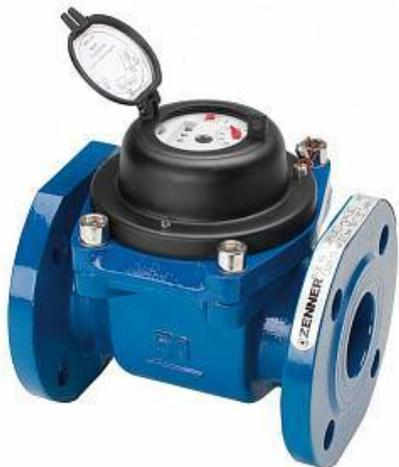
Турбинный водосчетчик типа Woltman с параллельной осью турбинки применяется там, где необходимо контролировать большие потоки с относительно постоянным поточным профилем. Они специально сконструированы для городских служб, коммунального водоснабжения и промышленности, и благодаря прочной конструкции могут работать не только с большим диапазоном измерений, но и отличаются высокой и стабильной измерительной точностью в течение долгого времени.
