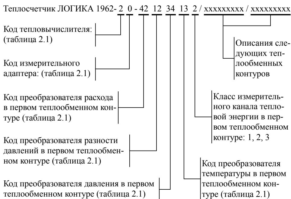
Рисунок 2.1 – Структура обозначения исполнений теплосчетчиков
